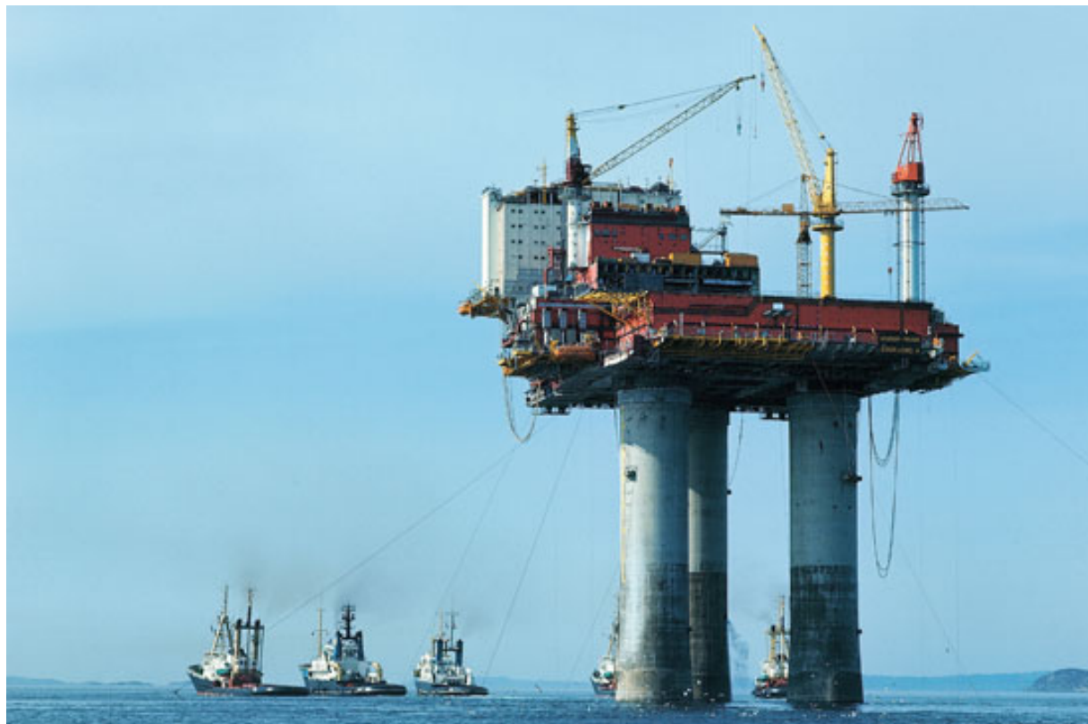
Figur 4. Statfjord A under slep ut til feltet.
