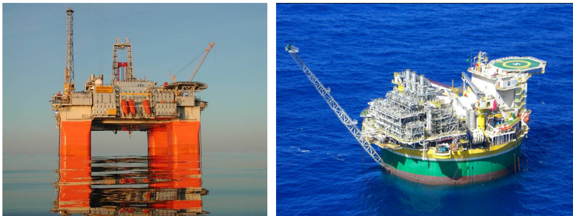
Figur 15: Eksempel på en semi (venstre) og en produksjonsinnretning fra Sevan (høyre)
