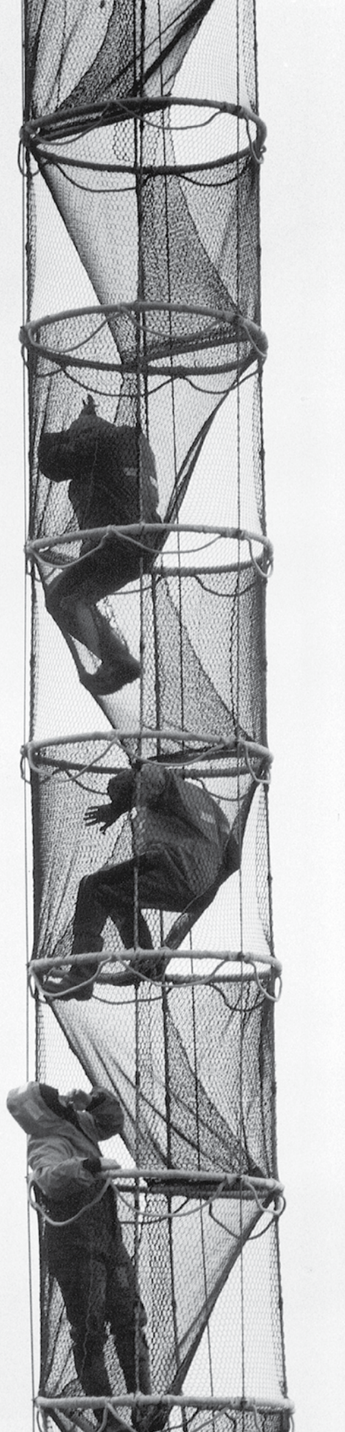
Rømningsstrømpen En viktig del av evakueringsutstyret offshore. (Foto: NTB scanpix/Samfoto)
